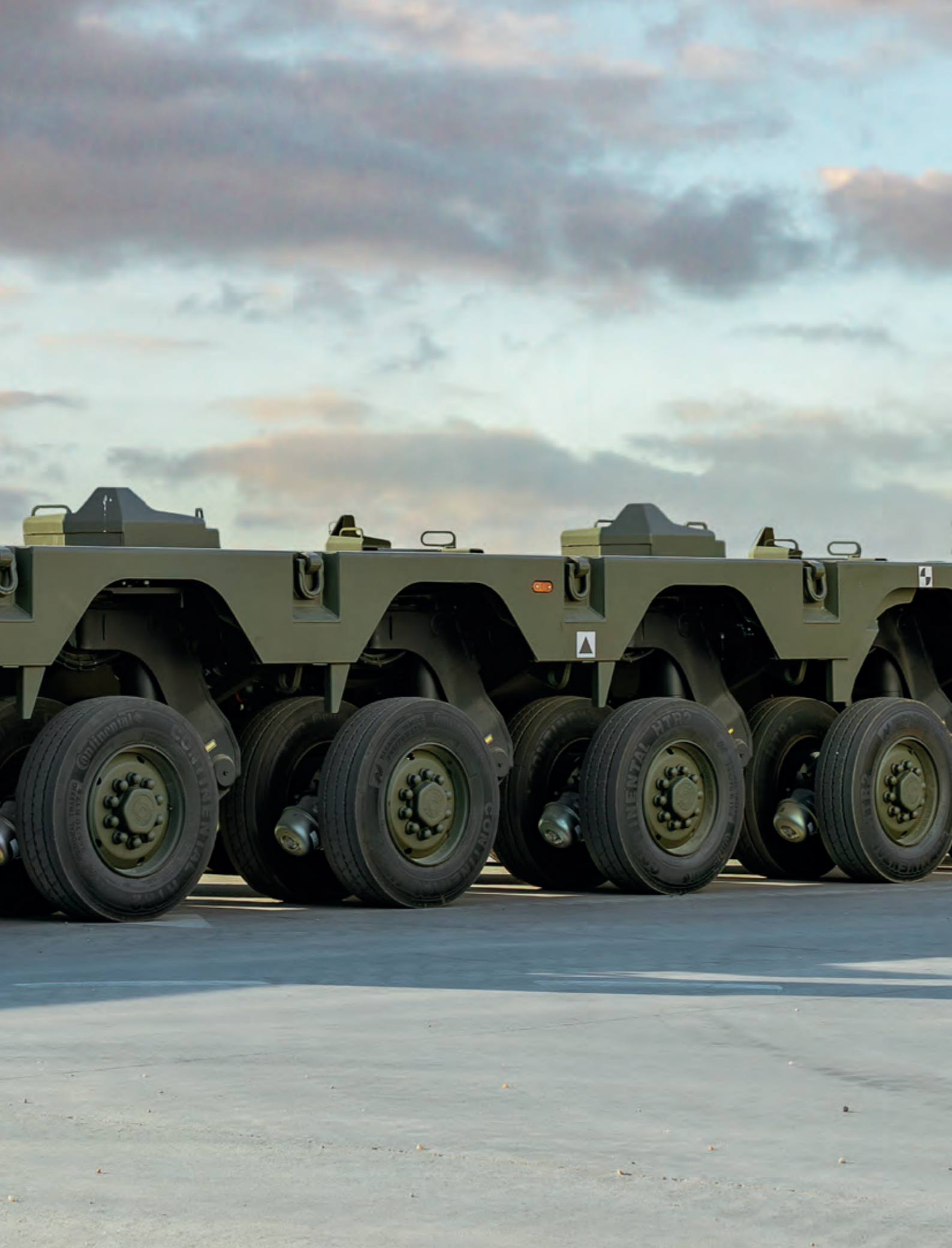
Idealna współpraca sztywnej konstrukcji stalowej z niezależnym zawieszeniem hydraulicznym.
