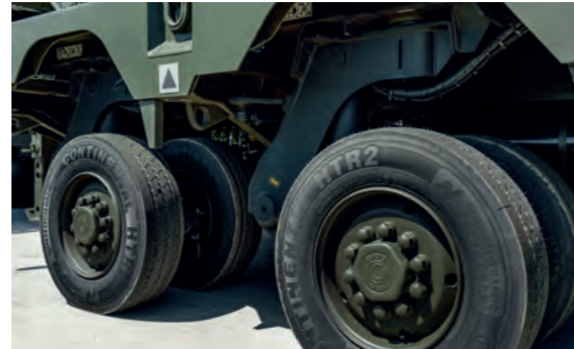
Idealna współpraca sztywnej konstrukcji stalowej z niezależnym zawieszeniem hydraulicznym.
